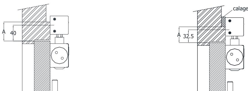
Si A est inférieur à 35mm, prévoir un montage avec 1 (BEMS) ou 2 (UCS) platines support dormant étroit.
